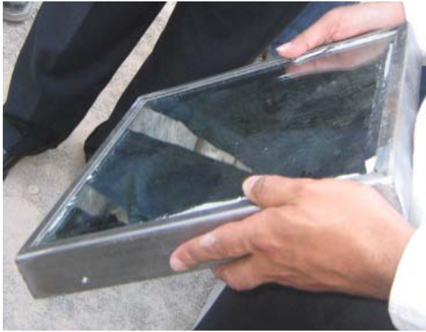
RESULTADO DE LOS IMPACTOS DE LOS PROYECTILES EN LA PROBETA MUESTRA, VISTAS POSTERIORES
