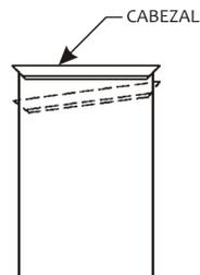
INSTALE EL CABEZAL EN LA POSICIÓN INDICADA A  $1"$  APROX. DE LA PARTE SUPERIOR Y EN EL CENTRO DEL VANO DE OBRA
