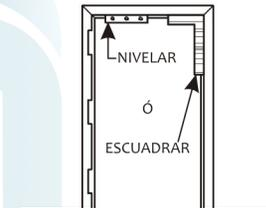
SI ES POSIBLE, COLGAR LA PUERTA Y AJUSTAR EL MARCO EN EL MURO PARA PERMITIR LAS ADECUADAS SEPARACIONES ENTRE PUERTA/MARCO O PLOMEÉ EL MARCO CON LA ESCUADRA Y/O EL NIVEL. (AJUSTE LA NIVELACIÓN DEL CABEZAL CALZANDO DEBAJO DE LAS PERNAS)
