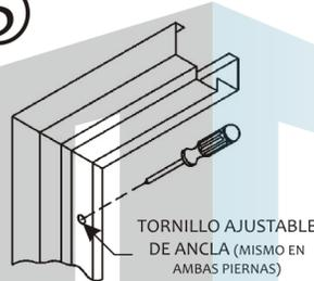
GIRE LOS TORNILLOS AJUSTABLES EN AMBAS PERNAS EN SENTIDO CONTRARIO A LAS MANECILLAS DEL RELOJ HASTA QUE EL ANCLA SE APOYE CONTRA EL MURO
