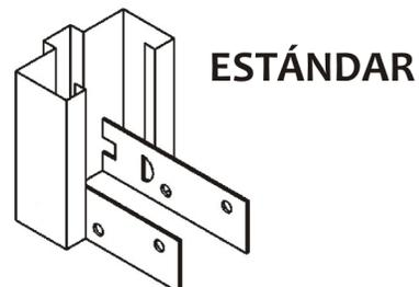
REVISAR LAS DIMENSIONES DEL VANO DE LA PUERTA EN LA BASE DEL MARCO (LAS MISMAS DIMENSIONES QUE ENTRE EL CABEZAL Y LAS PERNAS). ASEGURAR LAS PERNAS CON LOS TORNILLOS PARA TABLAROCA (NO SUMINISTRADOS) A TRAVÉS DE EK ANCLA DE SOLERA
