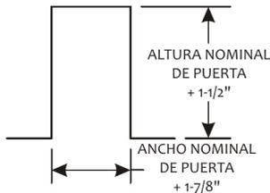
AUMENTAR A LAS DIMENSIONES DE LA PUERTA  $1-7/8"$  EN EL ANCHO Y  $1-1/2"$  EN LA ALTURA. (EJEMPLO) PARA UNA PUERTA 3068 EL VANO EN OBRA NECESARIO ES DE  $37-7/8" \times 81-1/2"$
