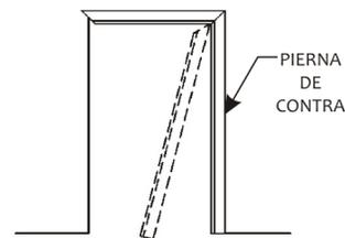
INSTALE LA PIERNA DE CONTRA DESLIZANDOLA SOBRE LA PARTE SUPERIOR DEL MURO Y ENGANCHANDO EL REFUERZO DE ESQUINA EN EL CABEZAL. COLOCAR LA PIERNA EN SU LUGAR
