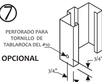
REVISAR LAS DIMENSIONES DEL VANO DE LA PUERTA EN LA BASE DEL MARCO (LAS MISMAS DIMENSIONES QUE ENTRE EL CABEZAL Y LAS PERNAS). ASEGURAR LAS PERNAS CON LOS TORNILLOS PARA TABLAROCA (NO SUMINISTRADOS) A TRAVÉS DEL AGUJERO EN LA BASE DEL MARCO. ASEGURARSE DE COLOCAR LOS TORNILLOS EN CADA LADO DE LAS PERNAS (4 PIEZAS)
